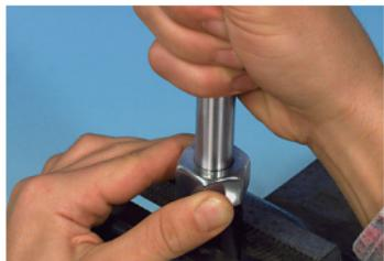
Helyezze a csövet, vágógyűrűt és roppantóanyát a VOMO-ra. Kézi erővel csavarja rá a roppantóanyát a VOMO-ra.
