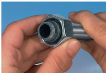
Lazítsa meg a hollandi anyát. A vágóél bemetszésének vizsgálata a csövön. A vágógyűrű élétől keletkező felgyűrődésének a cső teljes kerületén.
