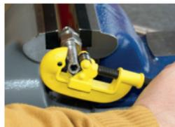
**Achtung:** Durch die Materialverdrängung entsteht eine Reduzierung des Durchgangs. Trotz Entgratung läßt sich diese nicht entfernen.
