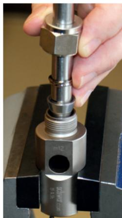
Wir empfehlen, bei der Montage eine 1/4 Umdrehung weniger anzuziehen, also **1 Umdrehung** bzw. bei kleineren Abmessungen eine 1/2 Umdrehung. Die verbleibende 1/4 Umdrehung erfolgt jetzt bei der **Fertigmontage im Stutzen**.
